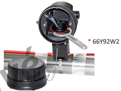
12 : Placer le joint dans le logement supérieur du pied, puis le boîtier au dessus. Orienter le boîtier selon la position souhaitée, puis placer et serrer l'écrou denté jusqu'au blocage.
