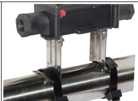
**3** : Une platine en acier inoxydable, pour montage décalé sur tuyauterie, permettant l'encliquetage du boîtier après la pose de l'isolation et de sa protection. Permettent une épaisseur d'isolant de **50mm**, ainsi qu'une utilisation sur des tuyauteries chaudes. Serrage sur tuyauterie métal ou PVC par serre-câble nylon ou collier de serrage métal. (Pattes disponibles en accessoire.)
