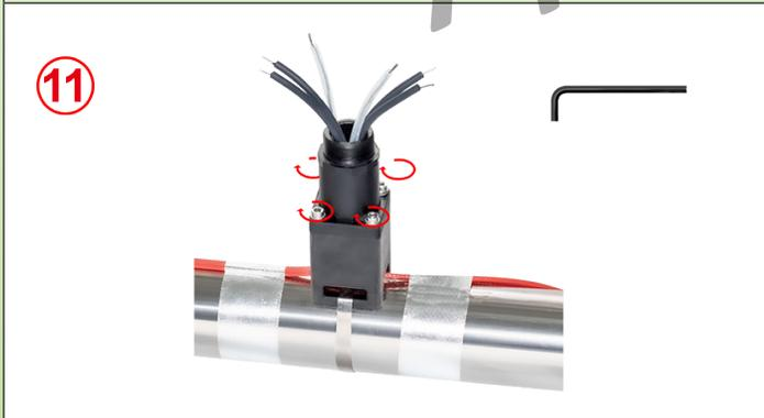
11 : Comprimer le joint d'étanchéité en vissant à fond la partie supérieure du pied avec les 4 vis jusqu'au moment où les deux parties du pied se touchent.
